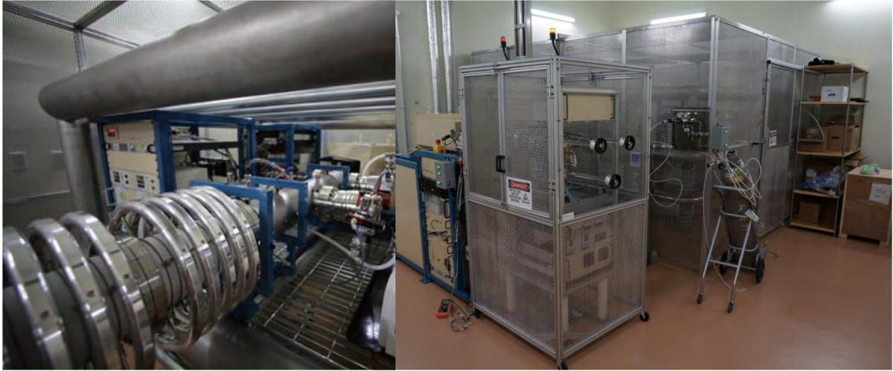
図3 日本で唯一のシングルステージ型加速質量分析装置
